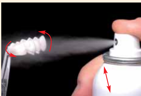
Pulverice IPS e.max Ceram Glaze Spray con intervalos cortos directamente sobre los materiales de Essence y/o Shades sin cocer desde todas direcciones.
